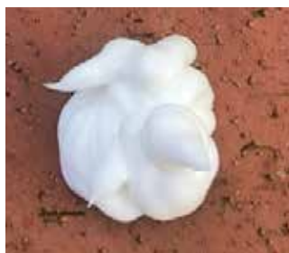
KÖSTER Crisin krema je čvrsta. To je velika prednost kadar delamo s kartušami ali alu črevi. Tudi če naneseemo preveč materiala v izvrtino, krema ne bo stekla po ometu, kar bi lahko povzročilo masten madež na površini. Odvečen material je mogoče enostavno odstraniti. Luknje se zatesnijo s hitrovezno malto, stene pa preplastijo s sanirnimi ometi.
